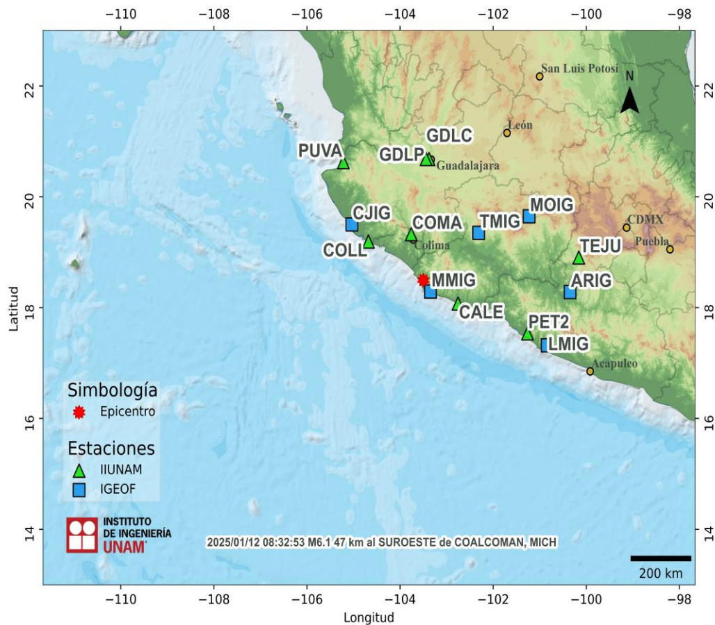
Figura 1. Epicentro del sismo del 12 de enero de 2025 (M6.1) y estaciones sísmicas empleadas en la elaboración del mapa preliminar de PGA. Las estaciones pertenecientes a la Red Acelerográfica del Instituto de Ingeniería de la UNAM (IIUNAM) son operadas por la Unidad de Instrumentación Sísmica. Las estaciones IGEOF mostradas son operadas por el Servicio Sismológico Nacional.
